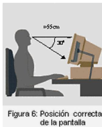
Figura 6: Posición correcta de la pantalla
